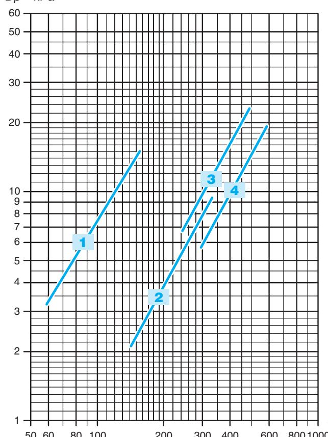
La perdita di carico si riferisce ad una temperatura media dell'acqua di **10°C**; per temperature diverse, moltiplicare la perdita di carico per il coefficiente **K** riportato in tabella.
